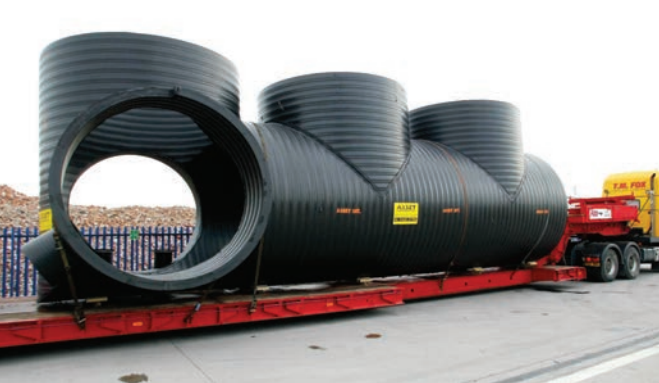
England: Præfabrikeret fitting, ID 3500 mm, udgør en del af en regnvandsbeholder med en samlet volumen på 300 m 3 og en vægt mindre en 5 ton. Installationen, inklusiv anlægsarbejde, tog to dage. Sammenlignet med traditionelle metoder har Weholite sparet flere ugers installationstid samt naboernes tålmodighed.
