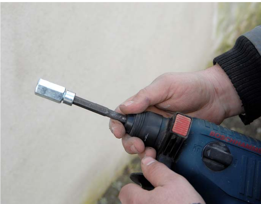
Fig. 7. Montageværktøj monteres i slag boremaskine.
