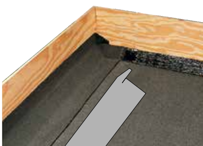
Indvendigt hjørne: Første understrimmel vist som principskitse
