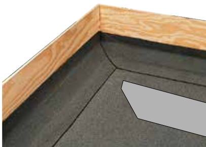
Indvendigt hjørne: Anden understrimmel vist som principskitse
