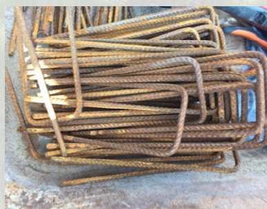
Nettet fastgøres til jorden ved hjælp af armeringsbøjler.
