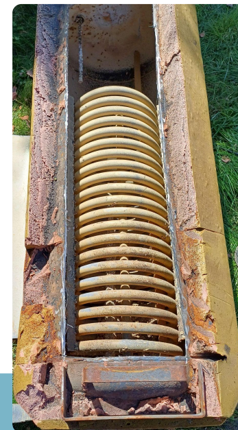
Kalkknuser-behandlet varmtvandsbeholder fra Langeland. (21 °dH).
