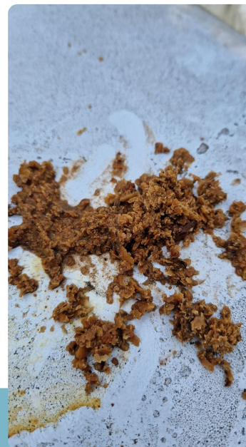
Ubehandlet varmtvandsbeholder fra Lejre. (17 °dH).
