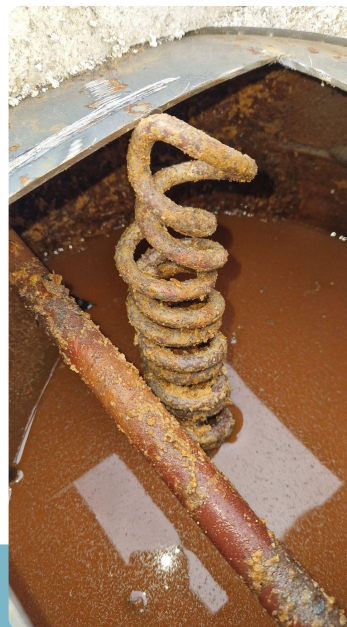
Ubehandlet varmtvandsbeholder fra Lejre. (17 °dH).
