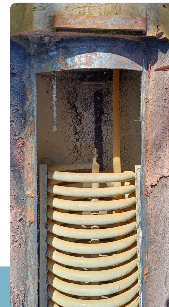
Kalkknuser-behandlet varmtvandsbeholder fra Langeland. (21 °dH).
