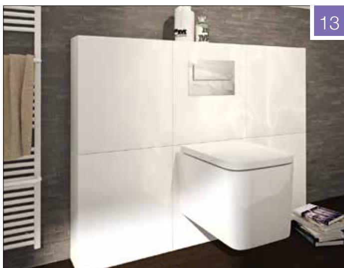
Fig. 13: JACKOBOARD® Sabo skal beklædes med fliser, for at sikre en jævn fordeling af tryk, når toiletet er i brug. Fliserne kan klæbes direkte på JACKOBOARD® Sabo. Alle typer af fliser kan i princippet bruges. De bør mindst måle 22x22mm, og være mindst 4mm tykke. Når fliselimen er hærdet, kan toiletkummen monteres.
