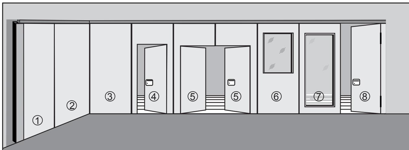
Um das vorhandene Raumangebot optimal ausnutzen zu können, erfordert dies eine Vielfalt an auswählbaren Elementtypen. Normalelemente (2) und Teleskopelemente (1) zum Herstellen des seitlichen Schlusses entsprechen den Anforderungen der modernen Architektur als grundlegende Lösung. Eckelemente (3) ermöglichen die Verfahrbarkeit der Trennwand über Eck. Standardwinkel von 45° und 90° verstehen sich als Gestaltungsvorschläge. Darüber hinaus gehenden Vorstellungen kann individuell entsprochen werden.
