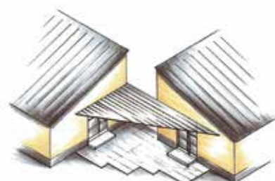
Halvtag mellem hus og udhus.
