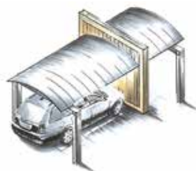
Halvtag mellem hus og udhus.
