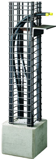
Energipælen er en traditionel funderingspæl opbygget i armeringsjern og beton, men med indstøbte jordvarmeslanger, hvori cirkulation af væske optager eller afgiver varme fra/til pælen og jorden.
